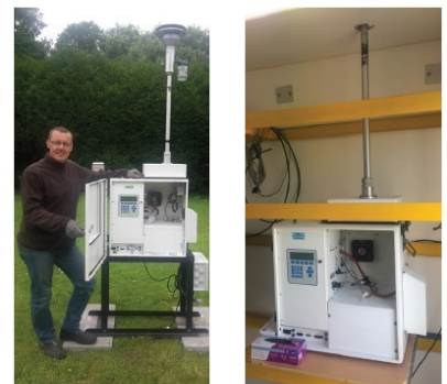
Appareils de mesures des pesticides à West-Cappel (59) à gauche et dans la station fixe de mesures de Saint-Quentin Stade (02) à droite © Atmo Hauts-de-France
